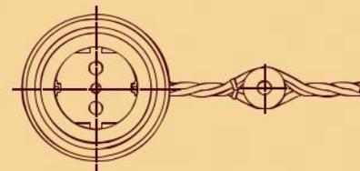
1. Определить и отметить центр местоположения розетки на стене.
