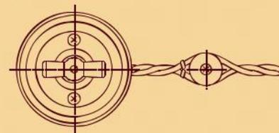
10. Установить корпус выключателя и закрепить при помощи крепежных саморезов.
