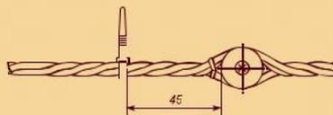
4. На расстоянии 45 мм. от изолятора на подводимом проводе закрепить хомутичную стяжку из комплекта выключателя.
