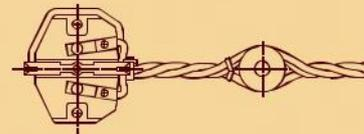
7. Подсоединить проводники подводящего провода к соответствующим контактам розетки.
