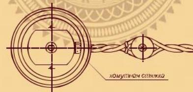
8. Установить основание выключателя таким образом, чтобы хомутичная стяжка, закрепленная на проводе, оказалась внутри него.
